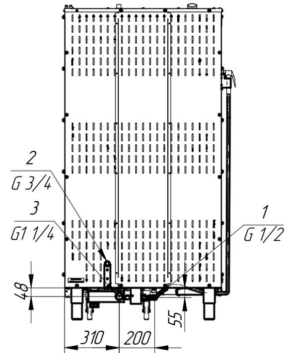
Минимальное расстояние от стены - 100 мм, от теплового оборудования - минимум 200 мм
